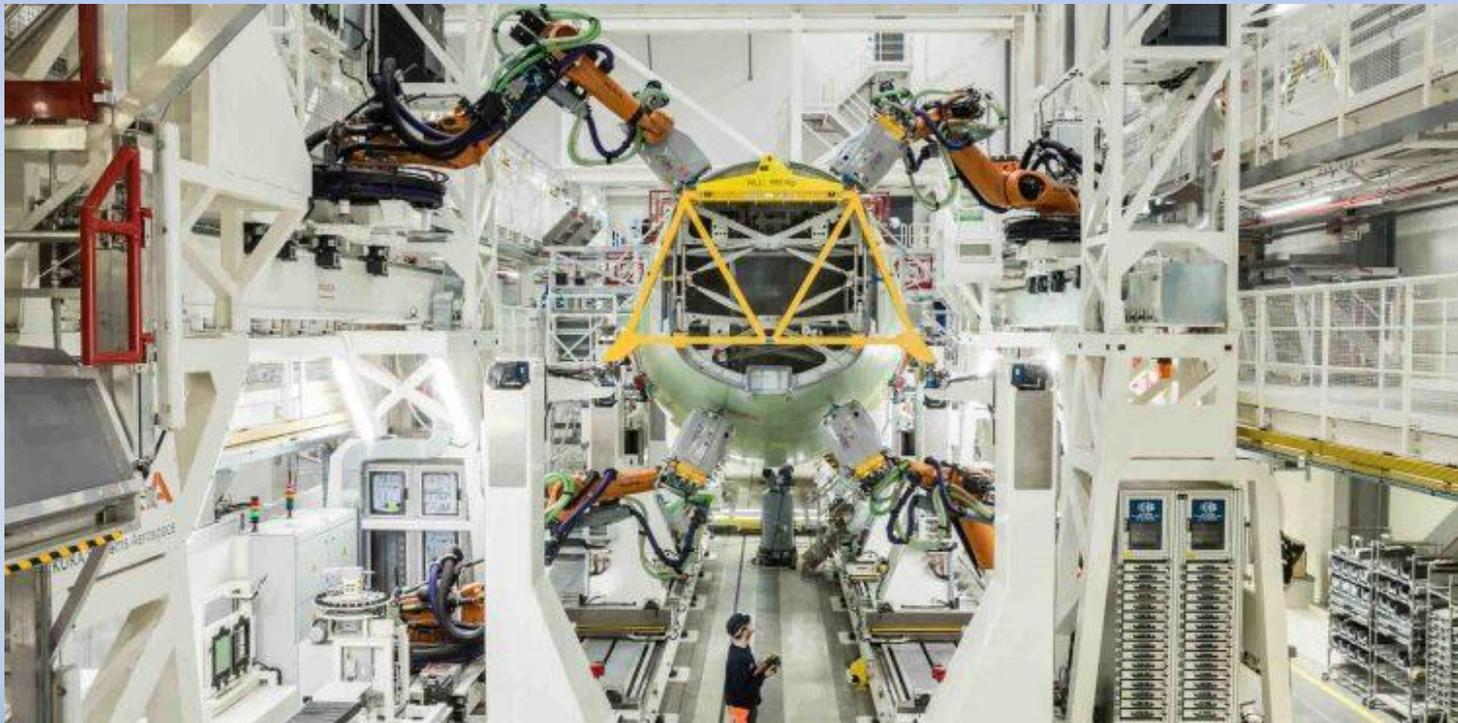
*Nueva línea altamente automatizada de montaje de estructuras del fuselaje para aviones A320 de Airbus (Hamburgo, 02/10/2019)*
